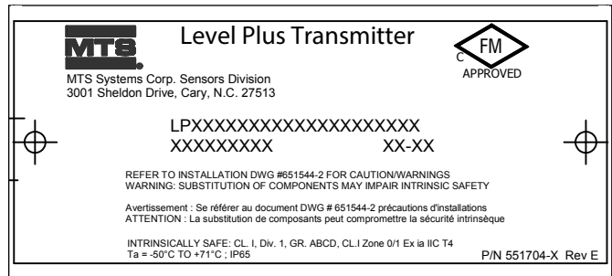
Fig. 34: Etiqueta FMC de seguridad intrínseca, HART®, carcasa con cavidad individual y doble
