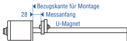
Abb. 6: Temposonics® Profilform mit U-Magnet OD33 7
