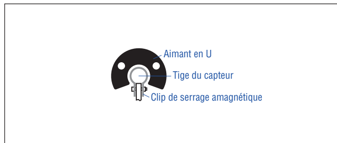
Fig. 12: Exemple de support de capteur (réf. 561 481)
